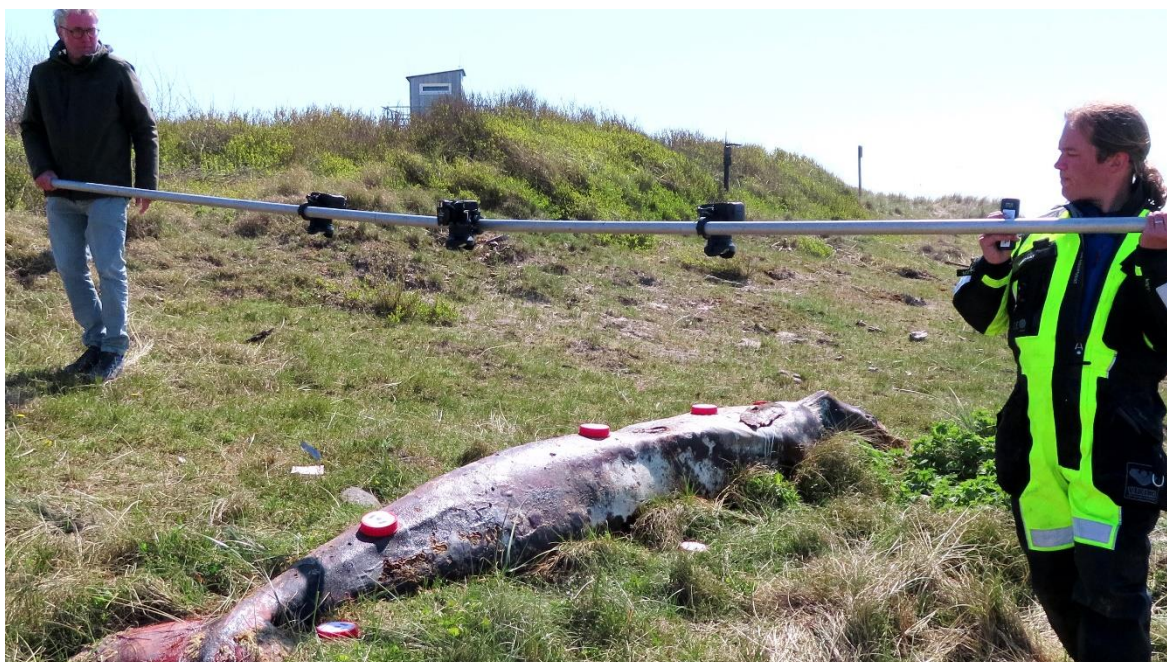
Figuur 4. Drie fotoestellen met groothoeklens en afstandsbediening voor het maken van de orthofoto's van het kadaver. Foto: Martin Baptist, Wageningen Marine Research, 28-04-2021.
